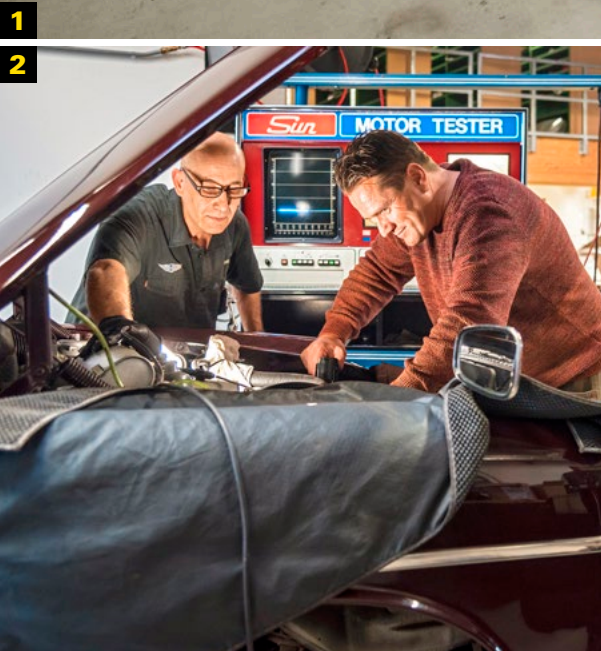
1 Engländer – was anderes wird sich bei Classic-Line nicht in der Werkstatt finden 2 Schmidt und sein Kollege Andreas Strauss checken die Zündung eines Rover P5
